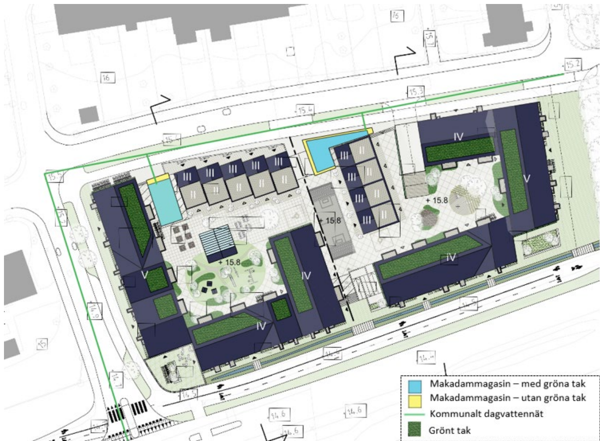
Figur 28. Illustration av placering för föreslagen dagvattenlösning. Marknivåer på innergård är föreslagna marknivå.
